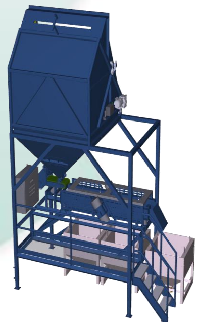
D'une caisse par une trémie de dosage vers une petite unité de calibrage/tamisage. Le dosage exact reste garanti!
