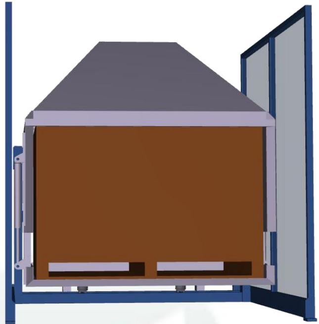
Grâce au levage et l'emboîtement, plusieurs types de caisses de dimensions différentes peuvent être basculées sans risque de fuites.
