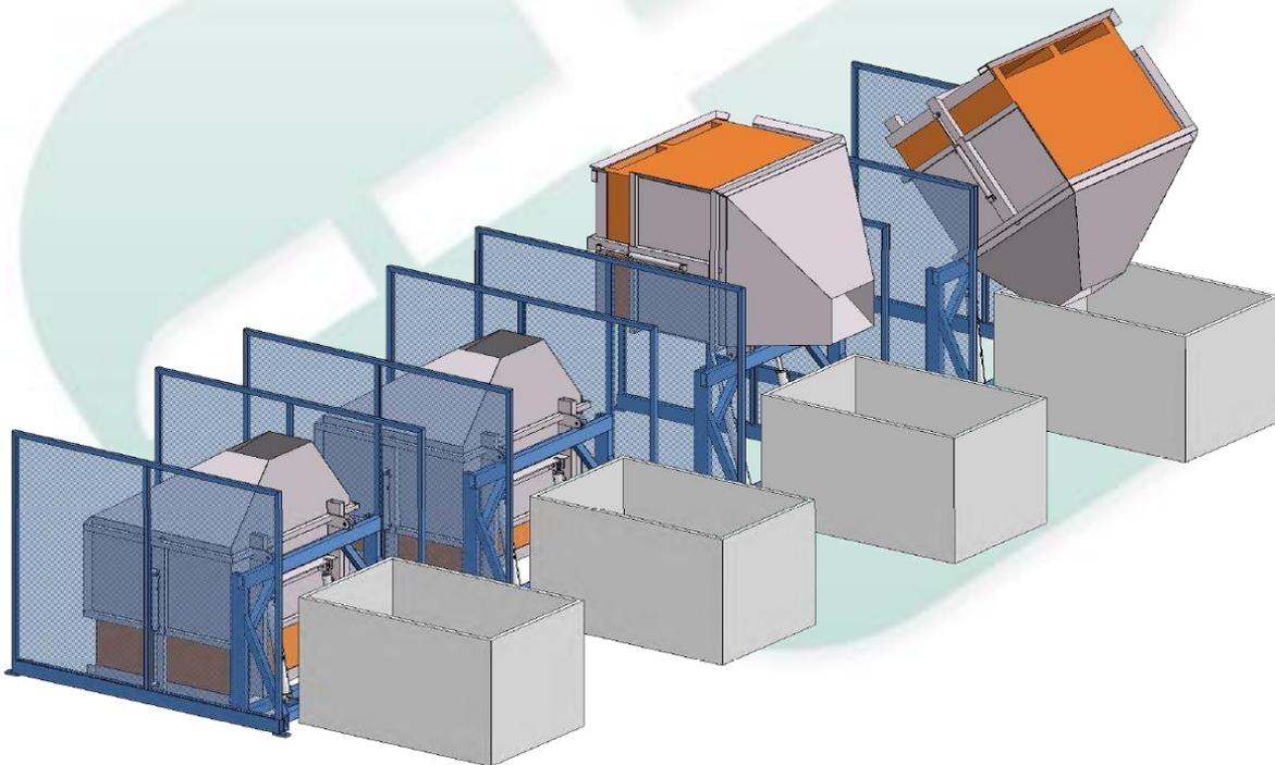
Ci-dessus : le processus de basculement. La sortie peut être adaptée selon les besoins. Eventuellement pourvue d'une trappe de dosage ou d'une adaptation pour la connexion sur un système d'aspiration de transport sous vide.
