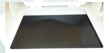
Une sonde de remplissage, située dans l'entonnoir ou le container, active l'unité pneumatique afin de maintenir à niveau dans le doseur ou trèmie.
