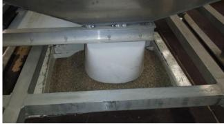
Le container-doseur rempli, dans cette configuration, un entonnoir de la machine placé en-dessous. Sur chaque plateau de la machine est fixé un entonnoir.
