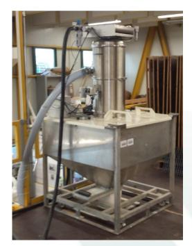
Pour les semences et les pilules, les critères sont différents; Le produit ne doit pas être abimé et le dosage doit être rigoureux. Les machines ne sont pas utilisées en continu et une unité pneumatique doit pouvoir être utilisable sur différentes machines.
