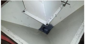
Après manipulation, la semence coule dans un petit entonnoir et est aspirée dans le fond par le tuyau.
