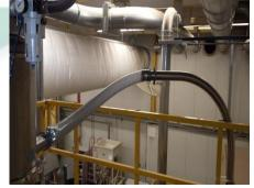
La semence est aspirée par un tube inox avec de larges courbes et soufflée vers une autre machine pour un prochain traitement.
