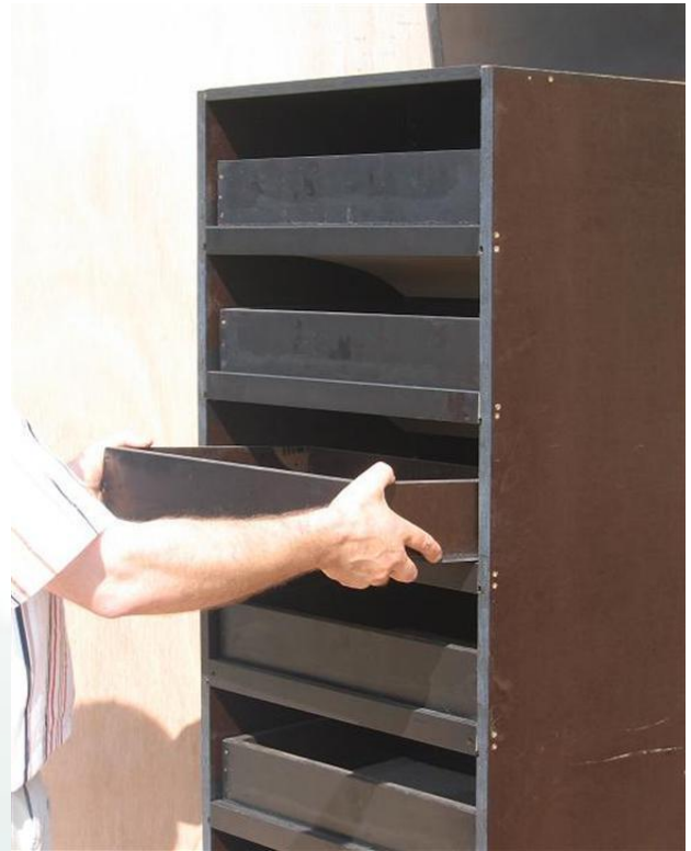
Volet d'admission de l'air s'ouvre lorsque le tiroir est mis en place.
