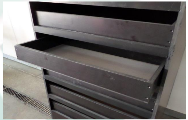
Entrée et sortie d'air par tiroir individuel.
