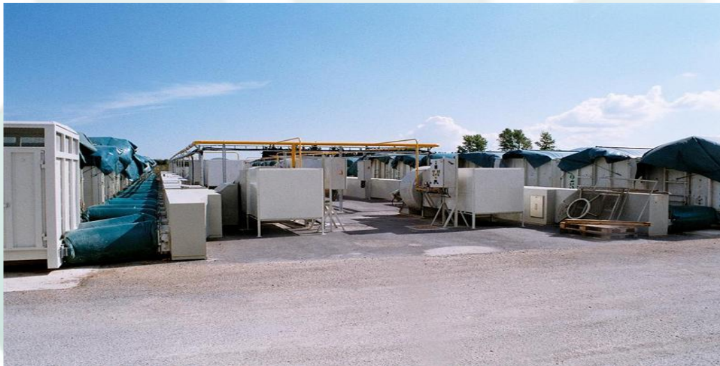
Unités de séchage avec ventilateurs, conduits d'air et les connexions pour les conteneurs.
