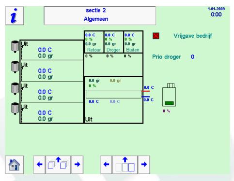
Visuel d'une section avec quatre caisses (gauche). Indication de la T° et de l'HR de l'air sortant. L'ensemble des caisses avec la même T° entrante (un radiateur d'eau chaude). En haut à droite, trois entrées pour l'air : l'air intérieur recyclé (gauche), l'air déshumidifié (milieu) en l'air extérieur (droite). Indication des conditions de l'air et pourcentage d'ouverture des volets.
