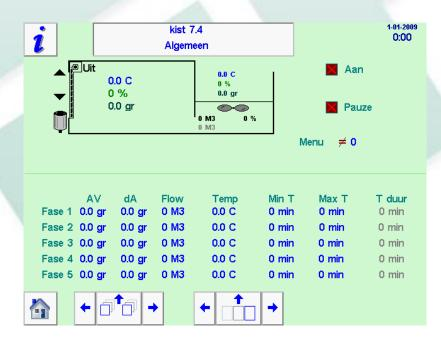
Chaque phase a une T° souhaitée. La consigne de T° maxi est dominante. Consignes, par phase, du temps de fonctionnement minimum et maximum et temps de fonctionnement dépassé. Par caisse: ouverture du volet roulant, consignes par phase; de l'HA souhaitée et la différence d'humidité entrée-sortie (dA). Quantité d'air souhaitée par phase.
