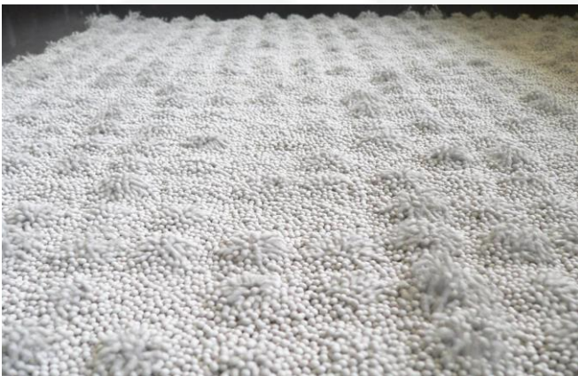
Séchage de pilules (jusqu'à 4 million par palox) en forme de petits volcans; rapide et soigné.
