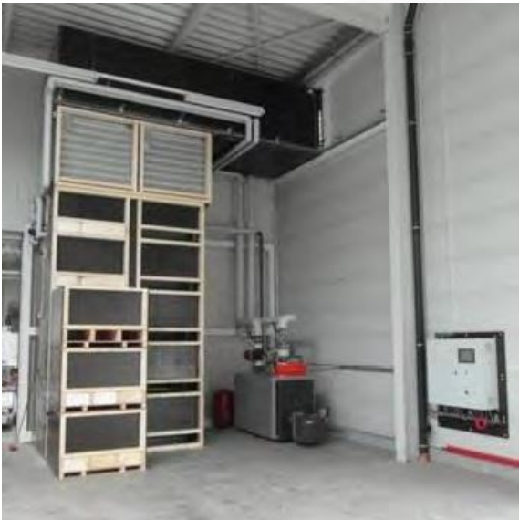
Visuel de l'installation de séchage à deux sections avec chauffage central.
