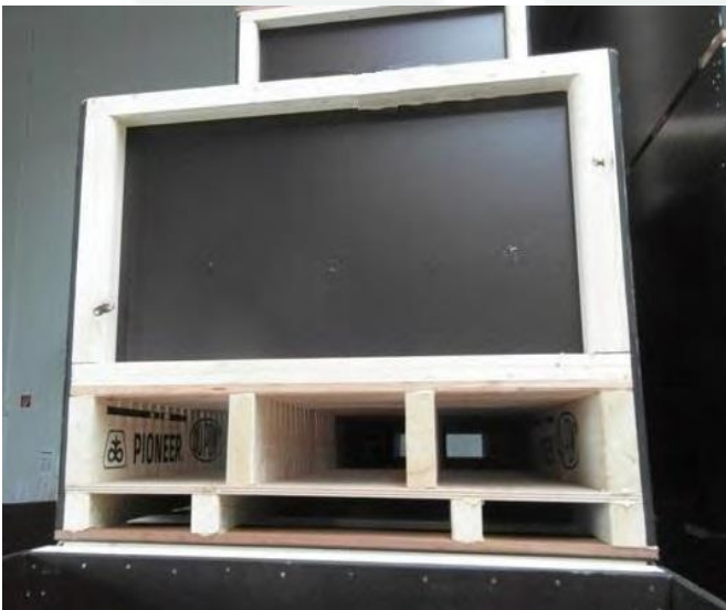
Exemple d'un palox de séchage à double palette; ventilation et transport. Extérieur du palox en «betonplex».
