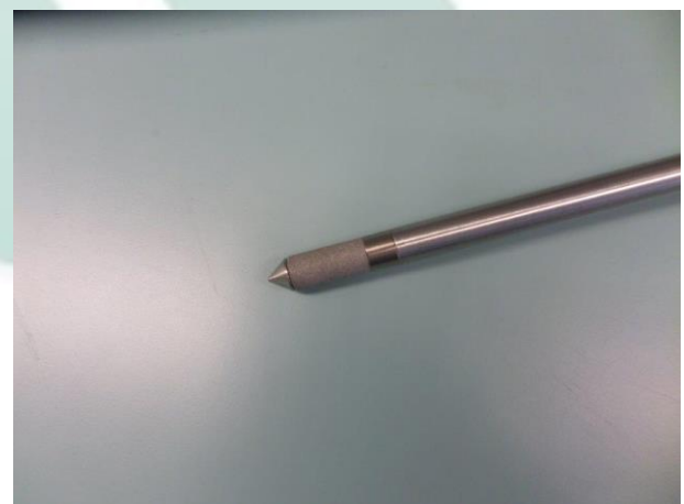
Mesure de la T° et HR à la pointe de la sonde
