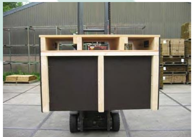
Le palox ne peut bouger entre les montants, la palette ne s'abîme pas. La semence s'écoule bien.
