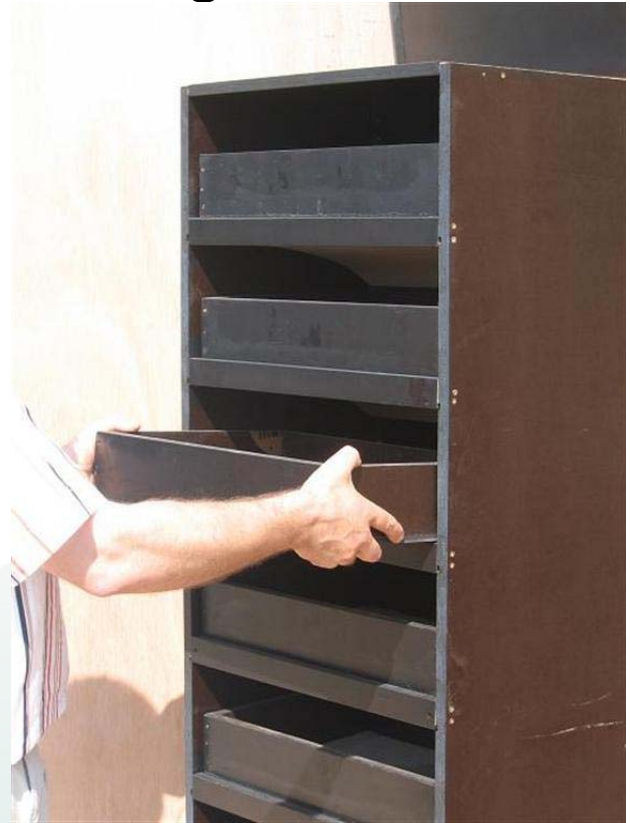
Volet d'admission de l'air s'ouvre lorsque le tiroir est mis en place
